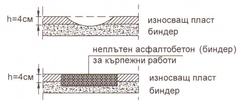
ДЕТАЙЛ No4 -Изкърпване на дупки
