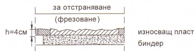
ДЕТАЙЛ No1 - Фрезование на повредени площи
